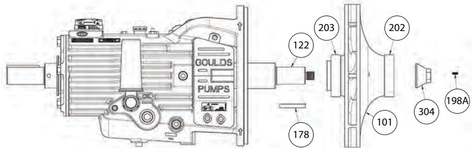
**Figure 64: Impeller**
